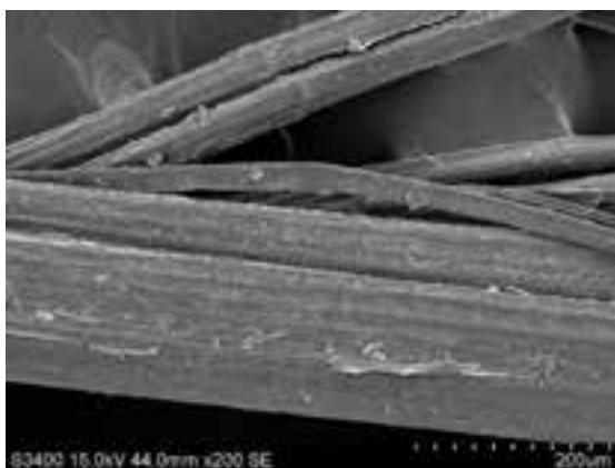
Rysunek 14. Mikrofotografia – widok wzdłużny włókien konopi. Źródło: Prace własne. Fot. A. Kicińska-Jakubowska.
