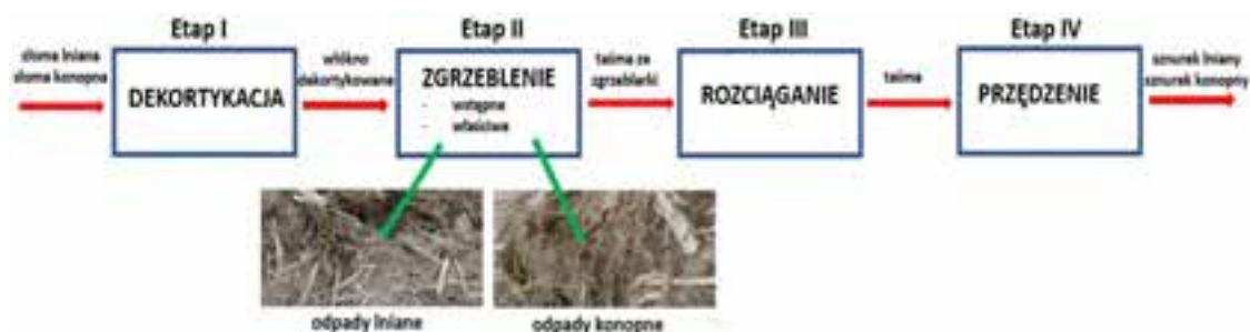
Rysunek 16. Schemat procesu wytwarzania sznurków lnianych lub konopnych. Źródło: Prace własne.
